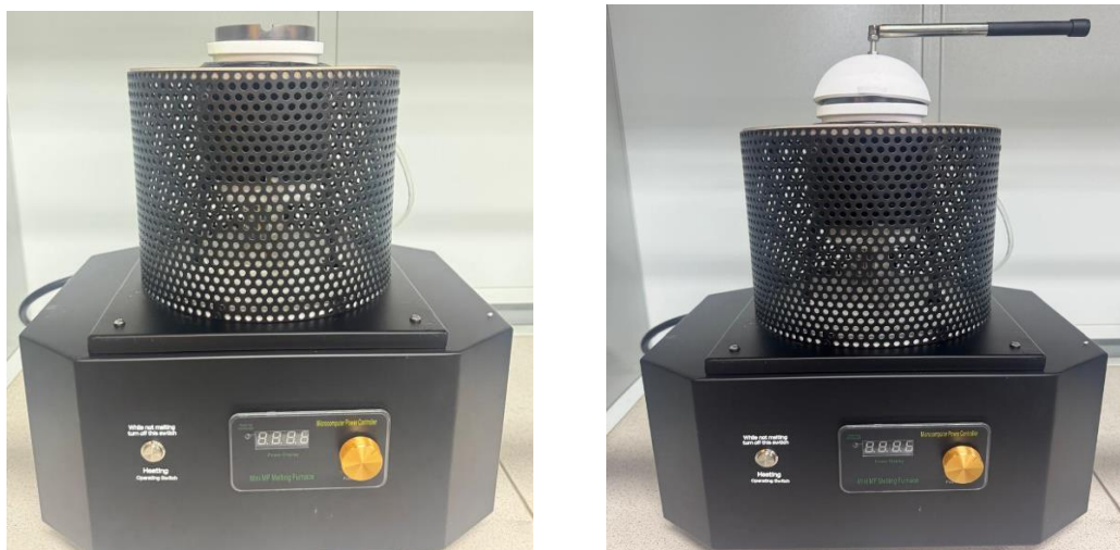
2.2-сурет – Тигельді типтегі зертханалық индукциялық электртермиялық пеш
